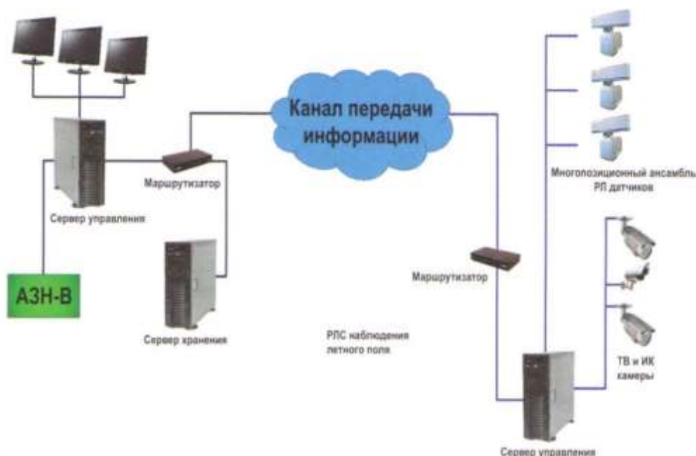
Рисунок 2 – Структура КСА «Наблюдение»
