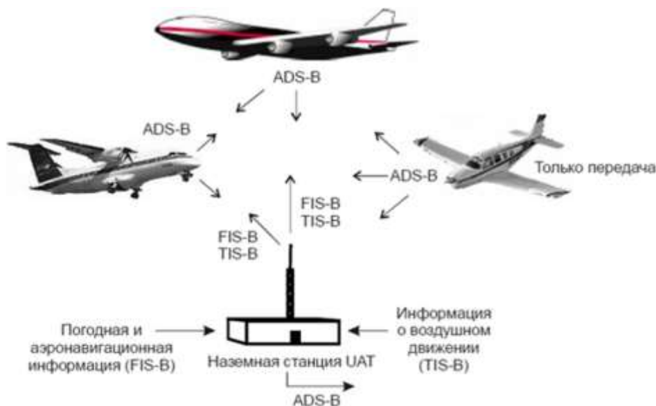
Рисунок 1 – Схема системы АЗН-В при использовании линии UAT
