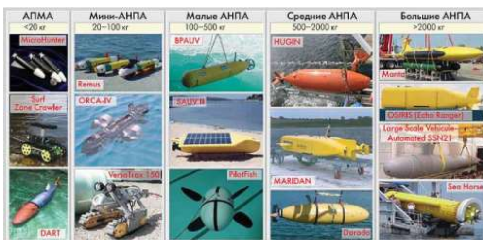
Рисунок 2 – Классификация АНПА по массе аппарата
