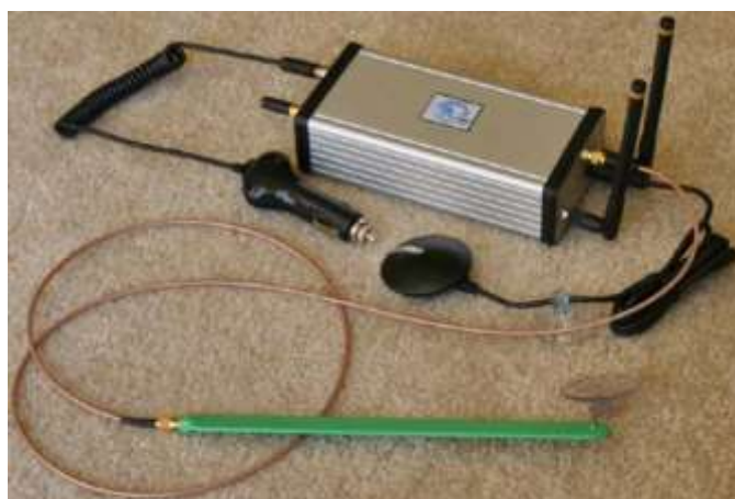
Рисунок 2 – Внешний вид транспондера UAT1000
