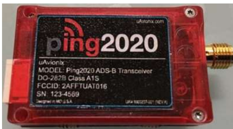
Рисунок 5 – Внешний вид транспондера Ping2020
