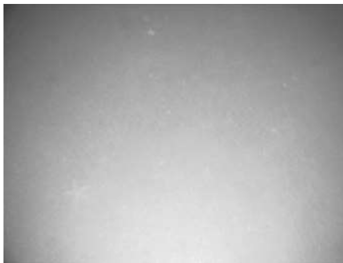
Рисунок 3 – Помеха обратного рассеяния снижает контраст изображения
