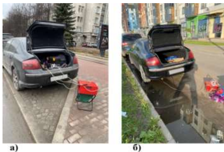
Рисунок – Замер концентраций загрязняющих веществ в выхлопных газах двигателя легкового автомобиля Peugeot 407:
