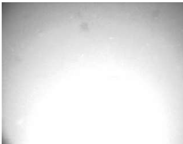
Рисунок 1 – Помеха обратного рассеяния при подводном наблюдении объектов. Камерная установка и светильники ПА находятся рядом и не разнесены в пространстве
