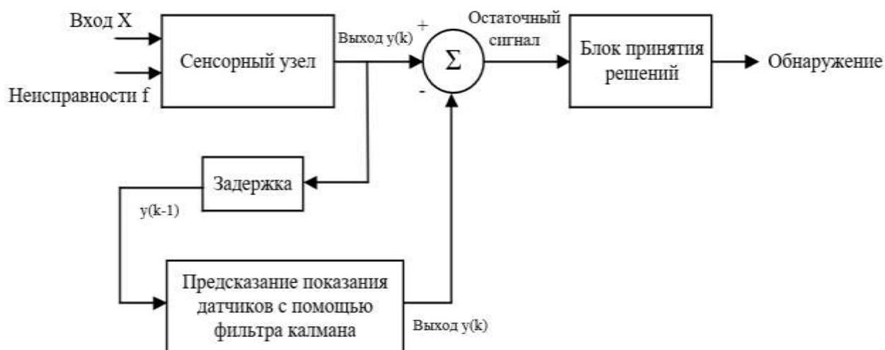
Рисунок 2 – Структурная концепция обнаружения неисправностей датчиков
