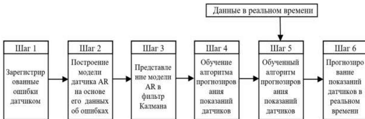
Рисунок 1 – Диаграмма прогнозирования показаний датчиков на основе авторегрессионной модели и фильтра Калмана
