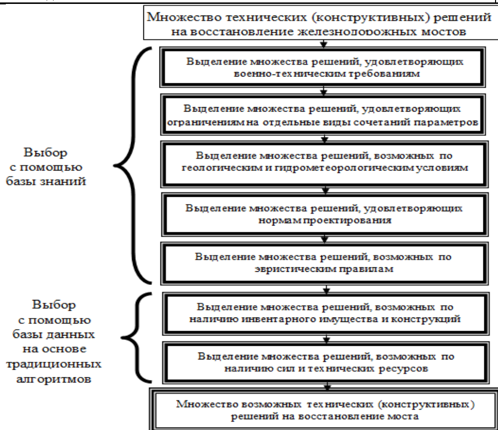
Рисунок 2 – Принципиальная последовательность определения множества возможных конструктивных решений
