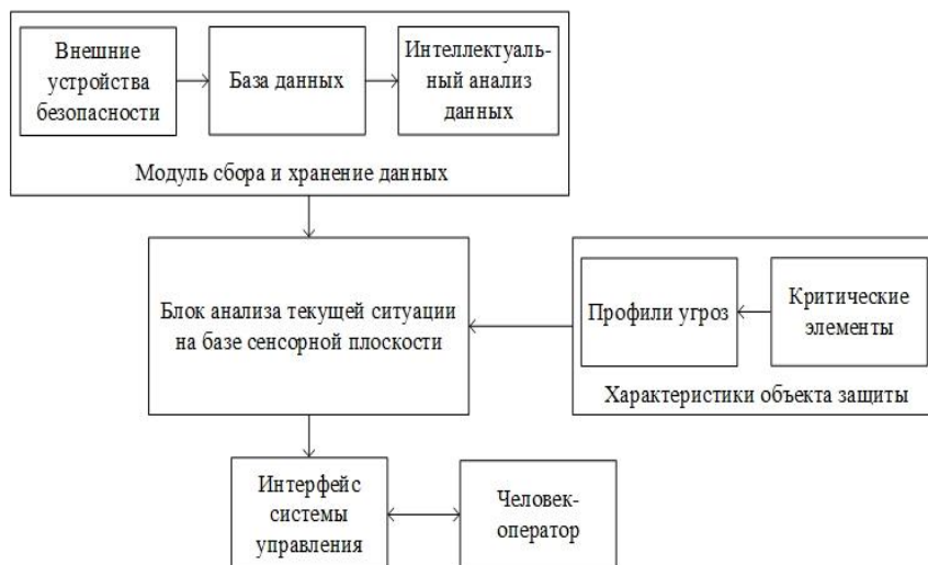
Рисунок 2 – Общая архитектура построения когнитивной системы авиационной безопасности
